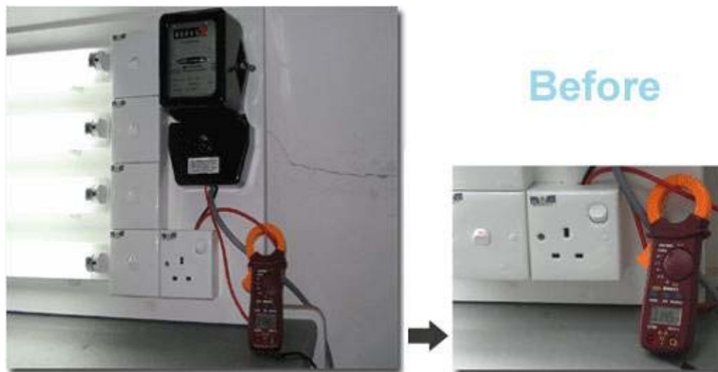
Obwod bez podlaczonego urzadzenia - odczyt 1.145
